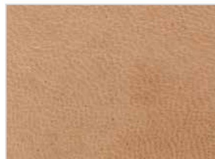
Pelle di montone spaccata, concia vegetale pura anilina in botte non rifinita. Possibile colorazione a tampone. Di aspetto liscio.
